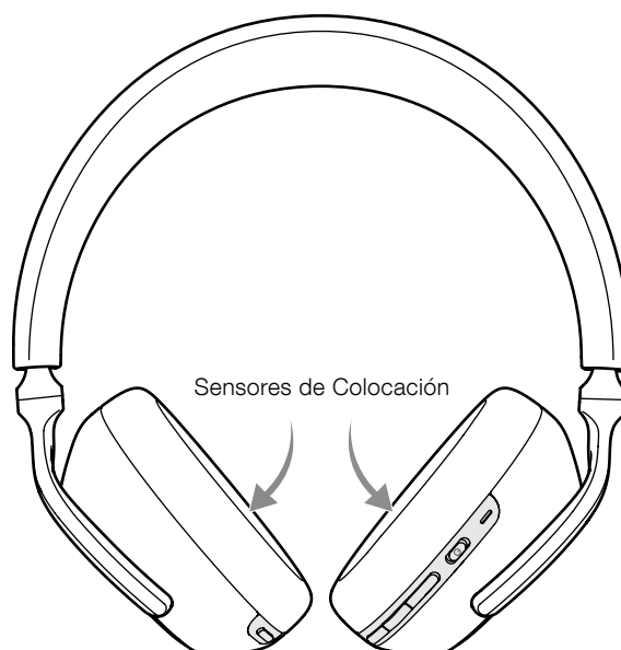
Diagrama 4 Ubicación de los sensores de colocación
