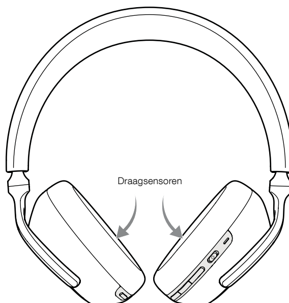
Figuur 4 Locatie van de draagsensoren
